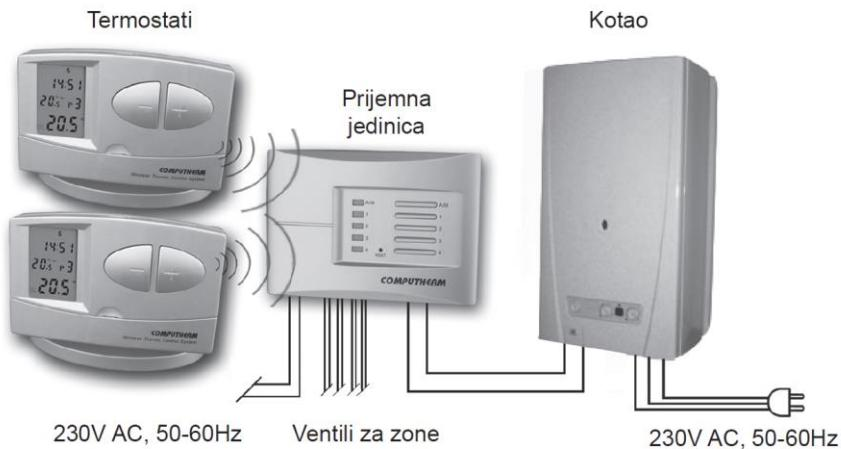
Radi produživanja životnog vijeka baterija, signaliziranje sa termostata nije stalno, već se ta komanda ponavlja svakih 8 minuta. Ako je jedno uključenje ili isključenje izostalo zbog prekida struje ili drugih razloga, onda će prijemna jedinica izvršiti zapovijed sa termostata kod sljedećeg slanja signala.
